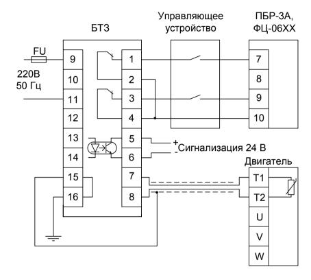
ПБР-3A, ФЦ06XX - безконтактные пускатели УУ - управляющее устройство (показано условно) БТЗ - блок тепловой защиты БТЗ-3 FU - плавкий предохранитель 0,25A 250B
